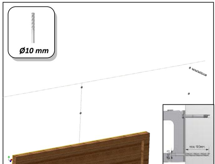
**DK:** Bor hullerne op med et Ø10 mm mur bor, til medfølgende expansions bolte (P05). Min. 90 mm. Boltene til fastgørelse kan kun bruges til beton og massive murstens vægge. Hvis udhænget skal hænges op på andet underlag skal anden befæstigelse anskaffes.
