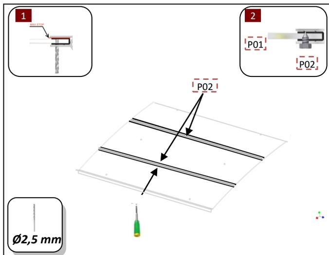
**DK:** Vend polycarbonat pladen om med bagsiden opad. Bor med et  $\varnothing 2,5$ mm bor i de forborede huller, MEN kun i gummilisten (P06) og polycarbonat-pladen (P01). IKKE I ALUMINIUMS-LISTEN. Bor KUN 5 mm ned (IKKE HELT IGENNEM). Monter de små medfølgende skrue (P02).
