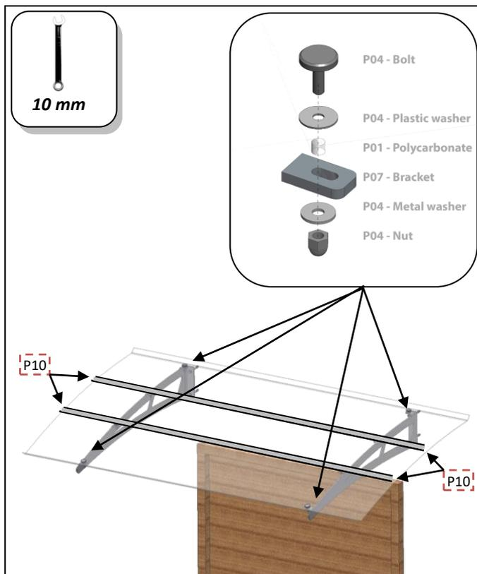
**DK:** Læg polycarbonat pladen op på knægtene og monterer den med de medfølgende (P04/P10) møtrikker/bolte. Plastik skiven skal ligge oven på pladen, spænd efter med en 10 mm nøgle. **Fugning:** Ønskes afstanden mellem bagkanten af udhængt og væggen helt tæt, kan denne forsegles med bygnings-silikone.
