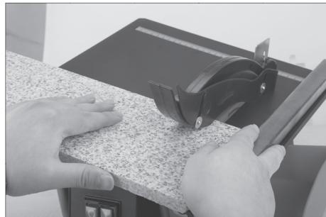
Sluk maskinen, og fjern først flisestykkerne, når diamantskiven holder helt stille.
