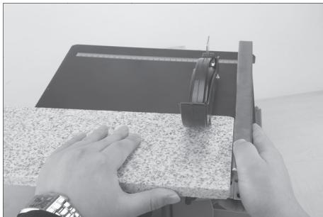
Slå av maskinen og fjern flisestykkene først når diamantskiven står helt stille.
