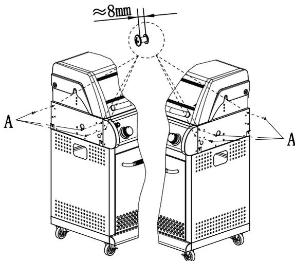
DK Skru 6 skruer (A) i hullerne på venstre og højre side betjeningspanelet på grillenheden (18), så de rager ca. 8 mm ud.
