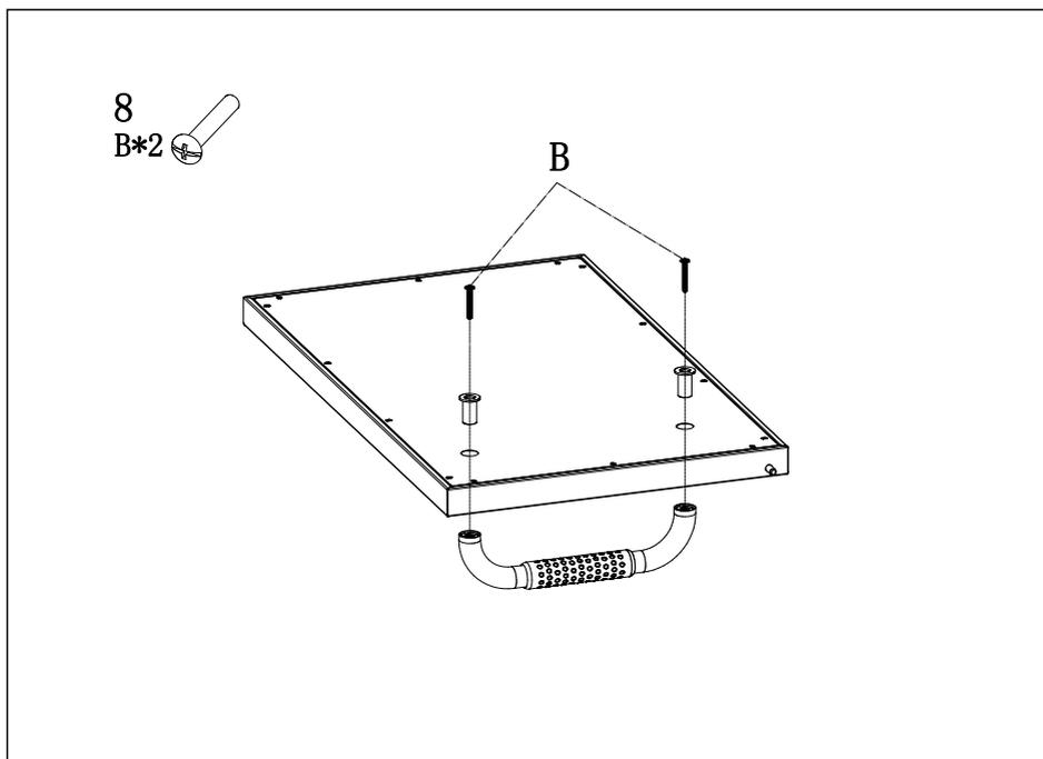
DK Monter håndtag (16) på højre dør (17) med skruer (B) og afstandsstykker (9).
