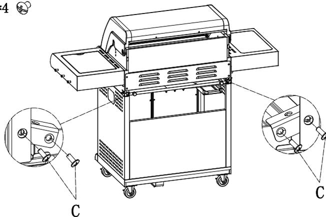
DK Monter drypbakkestoppet (5) bagfra på bagsiden af grillenheden med 4 skruer (C), så drypbakken ikke kan bevæge sig under brugen.
