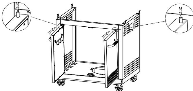
DK Indsæt døre ved at skubbe palen ned, så den klikker op i hullet på den monterede frontstøtte (19).
