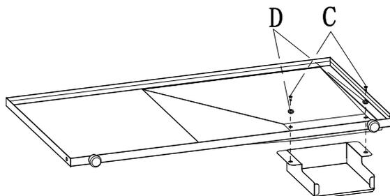
DK Monter drypskålholderen (15) på drypbakken (7) oppefra med 2 skruer (C+D).
