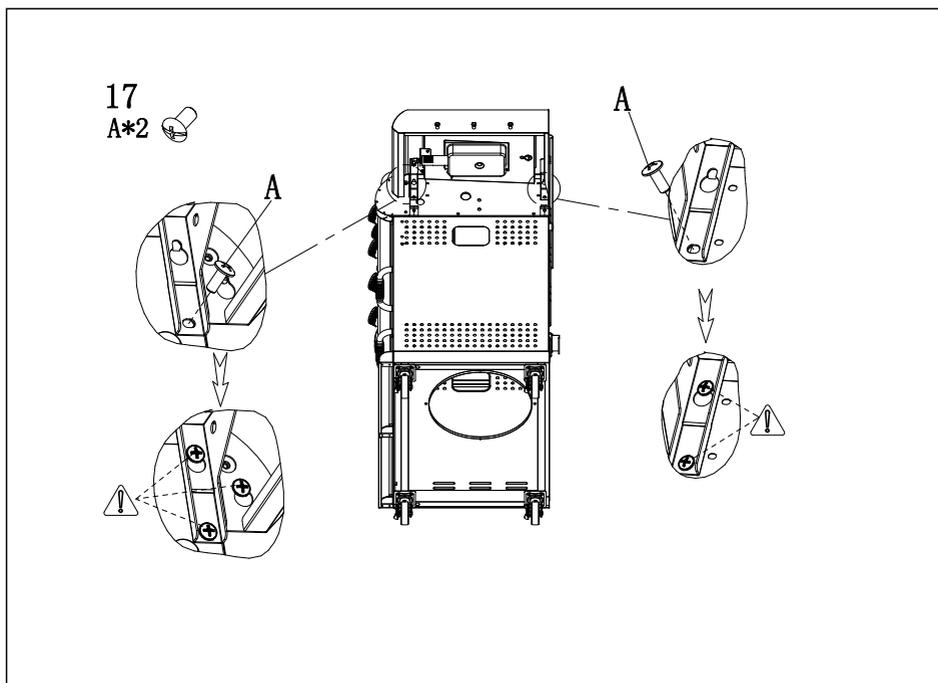
DK Skru det højre sidebord (25) fast på grillenheden udefra med 2 skruer (A) som angivet på tegningen.
