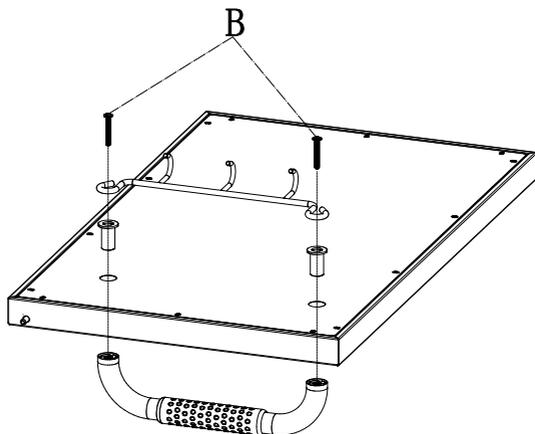
DK Monter håndtag (16) og redskabsholder (8) på venstre dør (10) med skruer (B) og afstandsstykker (9).
