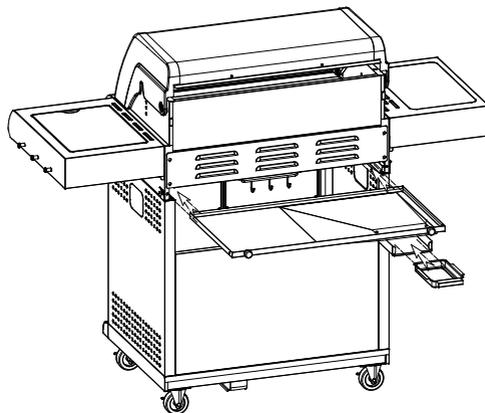
DK Anbring drypskålen (14) på drypskålholderen (15), og placer drypbakken (7) under grillenheden bagfra.
