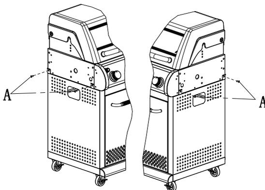
DK Placer grillenheden (18) på konstruktion og monter med skruer (A).
