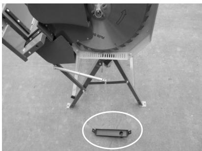
Montera den högra ytterskärmen (F) genom att skruva fast den tillsammans med den vänstra ytterskärmen med skruvar.
