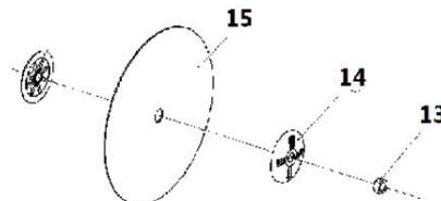
Løsne mutteren (13) forsiktig på motorspindelen, fjern den utvendige flensen (14) og løft sagbladet (15) ut. Vær oppmerksom på at sagbladet er veldig tungt. Vær forsiktig når du løsner mutteren og demonterer sagbladet, da det kan forårsake alvorlig skade!
