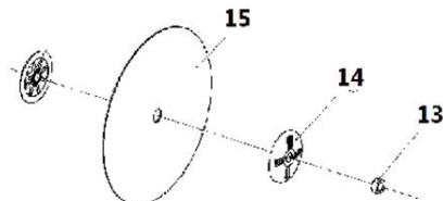
Løsn forsigtigt møtrikken (13) på motorspindlen, afmonter yderflangen (14), og løft forsigtigt savklingen (15) af. Vær opmærksom på, at savklingen er meget tung. Vær forsiktig ved løsning af møtrikken og afmontering af savklingen, da den kan forårsage alvorlig personskade!
