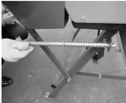
Tryk vuggen flere gange ind mod stellet for at kontrollere, at fjederen på stangen automatisk presser vuggen ud til sin oprindelige position igen.
