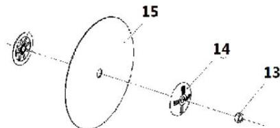
Lossa försiktigt muttern (13) på motorspindeln, ta bort den yttre flänsen (14) och lyft försiktigt bort sågbladet (15). Tänk på att sågbladet är mycket tungt. Var försiktig när du lossar muttern och tar bort sågbladet, eftersom det kan orsaka allvarliga skador!
