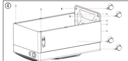
Fastgør (d) toppladen til (e) frontpanelet ved hjælp af 2 skruer (ST48). Brug 4 skruer (ST48) til at fastgøre bundpladen til venstre og højre sidepaneler. Fastgør venstre og højre panel til frontpanelet ved hjælp af 4 skruer (ST4\*8). (Se figur 5)
