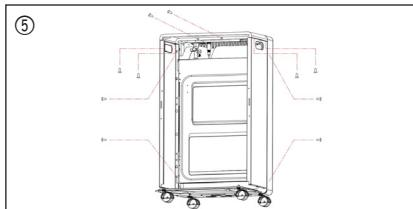
Placera (f) baksidan på två sidopaneler efter att du har placerat gasolflaskan på bottenplattan. (Se bild 6)
