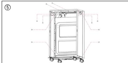
Placer (f) bagpanelet på de to sidepaneler, efter du har placeret gasflasken på bundpladen. (Se figur 6)
