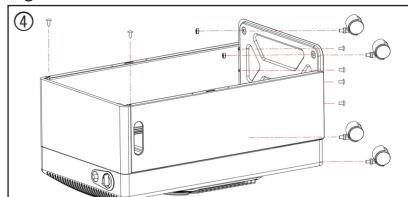
Fest (d) toppanelet på (e) frontpanelet ved hjelp av to skruer (ST48). Bruk fire skruer (ST48) for å feste toppanelet med venstre og høyre sidepanel. Fest venstre og høyre sidepaneler med frontpanelet ved hjelp av fire skruer (ST4\*8). (Se Figur 5)
