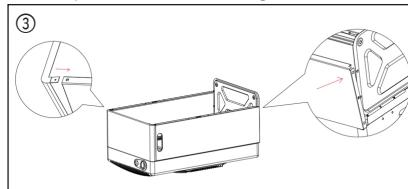
Fest to hjul direkte på undersiden av (e) frontpanelet, og fest to hjul med (c) bunnplaten ved hjelp av to medfølgende muttere (M8). Bruk fire skruer (M58) for å feste bunnplaten med venstre og høyre sidepanel. Fest hjørnepanelet med sidepanelene ved hjelp av to skruer (ST48). (Se Figur 4)
