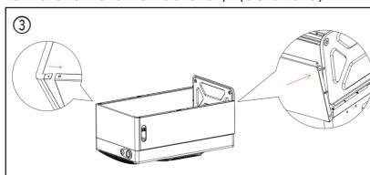
Fäst två hjul direkt på framsidans neder-sida (e) och fäst två hjul i bottenplattan (c) med hjälp av de två medföljande muttrarna (M8). Använd fyra skruvar (M58) för att fästa bottenplattan med vänster och höger sidopaneler. Fäst hörnpanelen på sidopanelerna med hjälp av två skruvar (ST48). (Se bild 4)
