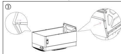
Fastgør to hjul direkte på bunden af (e) frontpanelet og fastgør to hjul til (c) bundpladen ved hjælp af 2 medfølgende møtrikker (M8). Brug 4 skruer (M58) til at fastgøre bundpladen med venstre og højre sidepaneler. Fastgør hjørnepanelet til sidepanelerne ved hjælp af 2 skruer (ST48). (Se figur 4)
