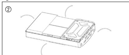
Sæt hjørnepladen i sidepanelet og sæt bundpladen i sidepanelet (sidepanelerne skal vende udad). (Se figur 3)
