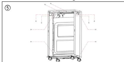
Plasser (f) bakpanelet på de to sidepanelene etter at du har plassert gassylinderen på bunnenplaten. (Se Figur 6)
