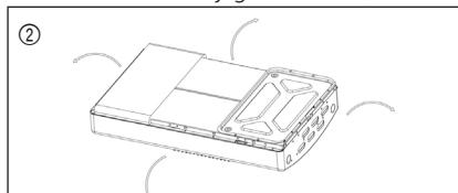
Sätt in hörnplattan i sidopanelen och sätt in bottenplattan i sidopanelen (sidopanelerna ska vara vända utåt). (Se bild 3)
