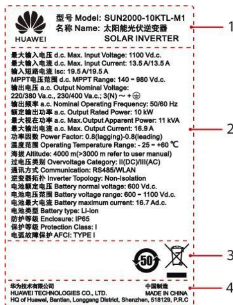
Figur 2-5 Typeskilt (med SUN2000-10KTL-M1 som eksempel)
