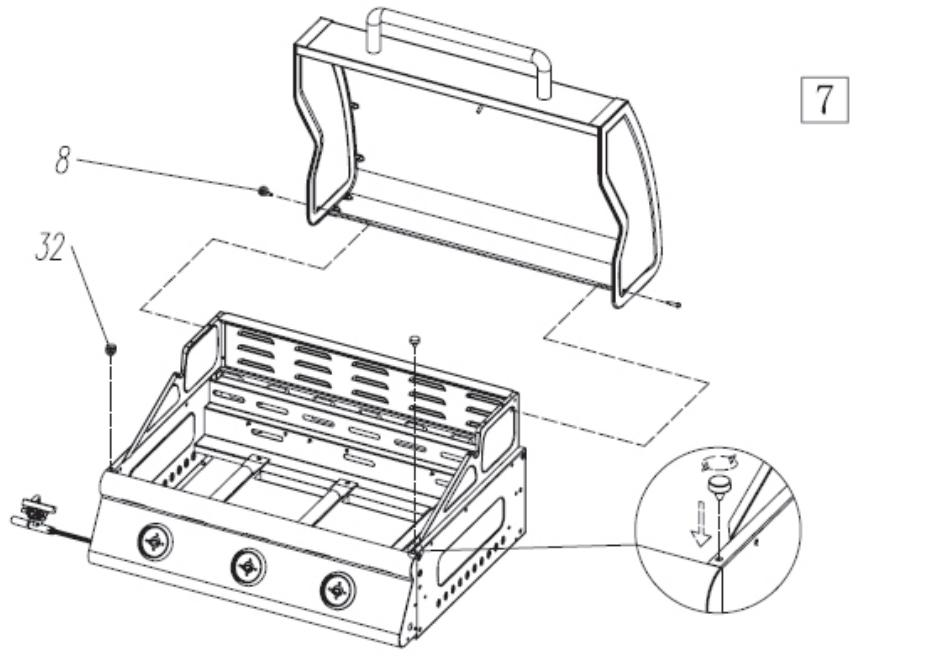
DK Monter det samlede låg på grillkassen med skruer (8) og gummidupper (32).
