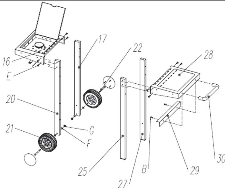
DK Saml stel og sideborde i forhold de på tegningen angivne elementnumre. Vær opmærksom på at bruge de korrekte skruer i forhold til det bogstav de er angivet med. Ligeledes at de korte ben er til siden hvorpå hjulene skal monteres.
