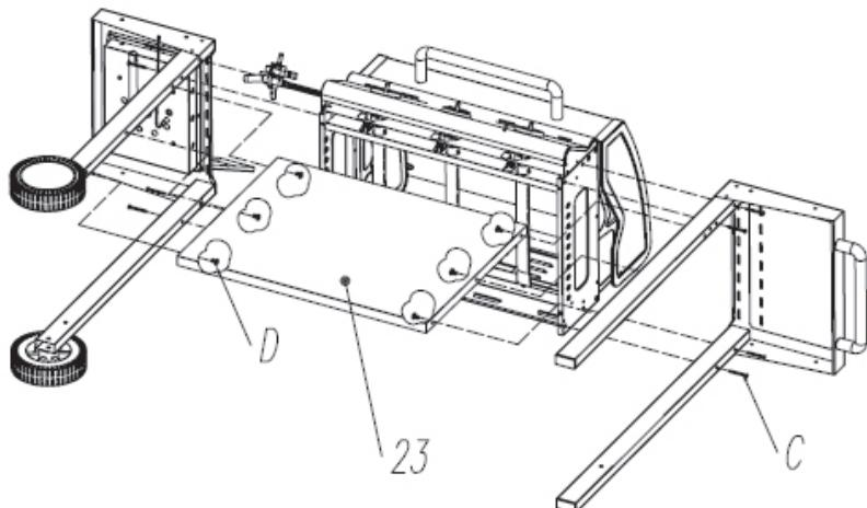
**DK** Placer forsiktig selve grillkassen på ryggen. Monter begge sideelementer på hver sin side af grillen med skrue (C). Hver opmærksom på at siden med sidebrænderen, monteres på den rigtige side. Efter siderne er monteret indsæt frontpladen (23), så skruerne (D) monteres bag pladen.
