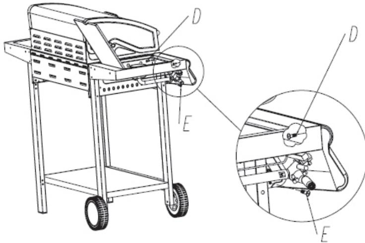
DK Montér venstre sidebordsfront (26) med 2 skruer (D) bagfra og en skrue (E) for at stabilisere frontpladen.
