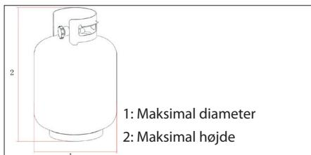
Den maksimale diameter og den maksimale højde på gasflasken er henholdsvis 310 mm og 500 mm, som vist nedenfor.
