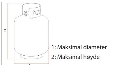
Den maksimale diameteren og den maksimale høyden på gassflasken er henholdsvis 310 mm og 500 mm, som vist nedenfor.
