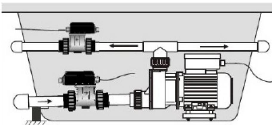
**LET OP:** De verbindingbuis/slang moet dezelfde diameter hebben als de rest van het buizensysteem in de spa/het bubbelbad.
