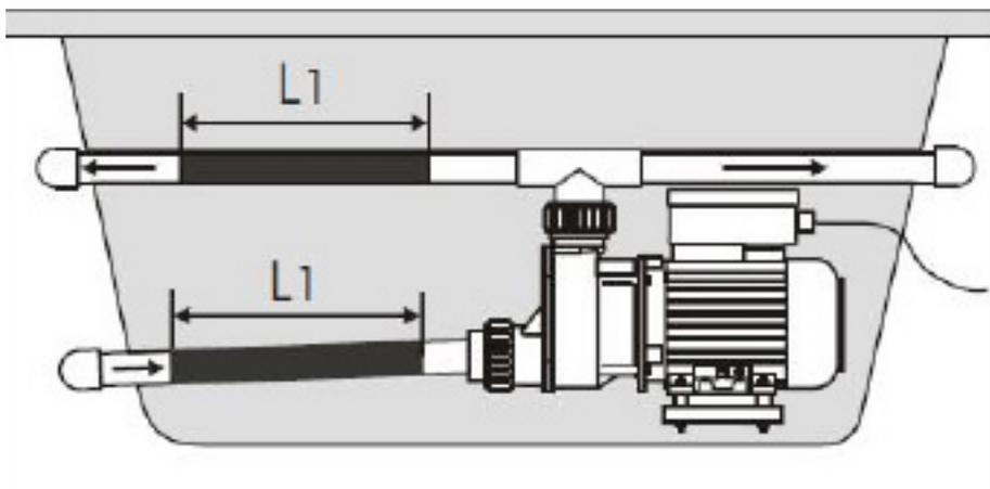
3. PVC-slange (figur 3) Skjær til en passende lengde PVC-slange fra pumpens inntak eller utløp, og koble den til varmerens monteringsventil.
