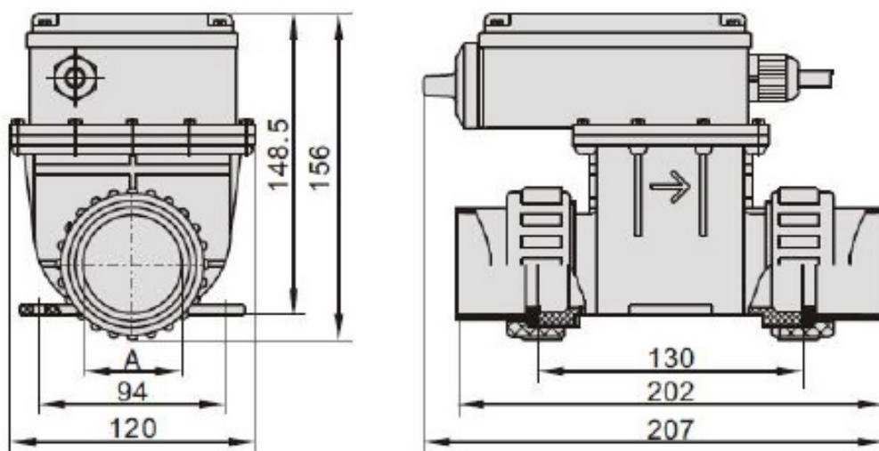
2. Varmeren kan kobles til pumpeanleggets inntak eller utløp (figur 2).
