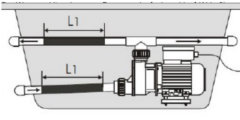
3. PVC-Rohr: (Abb. 3). Schneiden Sie ein passendes Stück PVC-Rohr/Schlauch vom Ablauf/Wassererhitzers.
