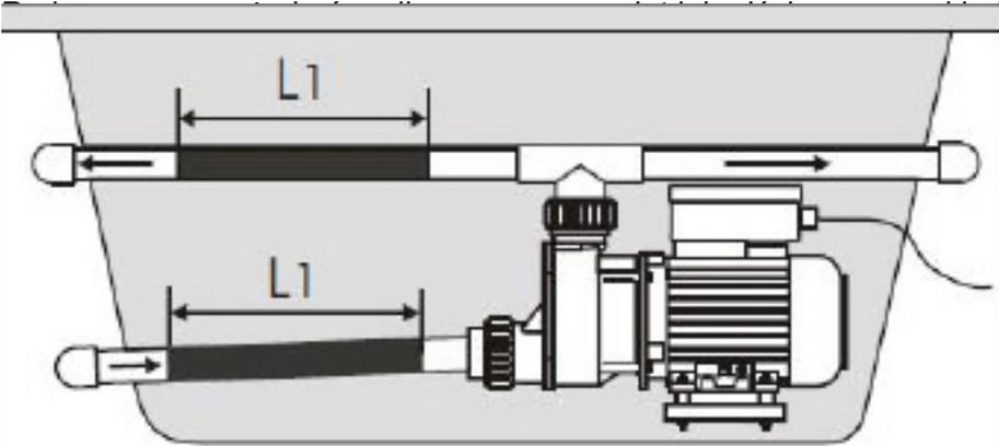
3. Rury PVC: (rys. 3) wyciąć odpowiedni kawałek rury PVC/węża od dopływu/wylotu pompy
