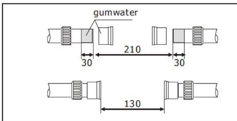
5. Installatie van de verwarming: (Fig. 5) Sluit de slang aan op de slangkoppeling van de verwarming. Controleer of de verbinding goed vastzit. Houd er ook rekening mee dat de onderdelen van kunststof zijn en daarom kunnen breken als de koppelingen te strak worden aangedraaid.
