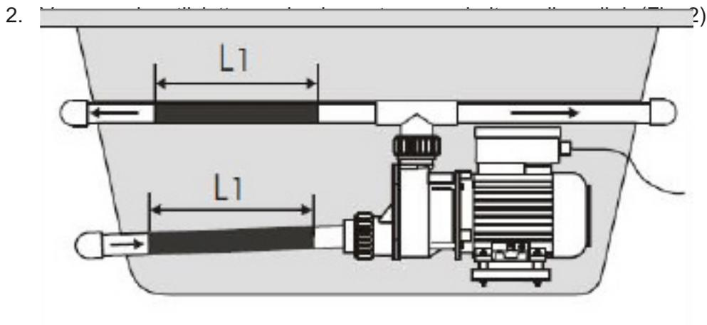
3. PVC rør: (fig 3) Skær et passende stykke PVC rør/slange fra pumpens udløb/returløb og
